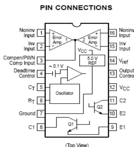
ای ایسی که در منابع تغذیه سویچینگ کاربرد دارد ، تهیه کننده کننده پالس pwm برای راه اندازی ترانزیستور های قدرت میباشد دیتا شیت
