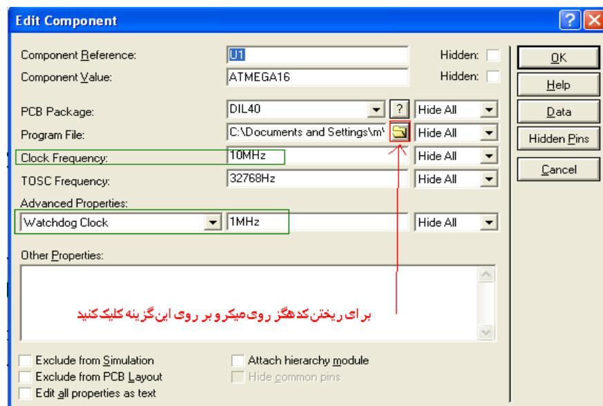
بعد از اعمال تنظیمات بر روی ok کلیک کنید ، مدار شما اماده شبیه سازی است ، در قسمت کنترل بر روی play کلیک کنید تا شبیه سازی شروع شود ، مشاهده میکنید که دمای نمایش داده شده بر روی سنسور بر روی lcd نیز نمایش داده می شود:
