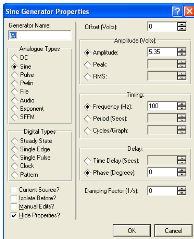
مقادیر موجود در شکل بالا را وارد کنید و شبیه سازی را اغاز نمایید مشاهد میکنید که شکل موجی با فرکانس 100 هرتز و ولتاژ 5.35 ولت روی اسیلوسکوپ نمایش داده میشود .
